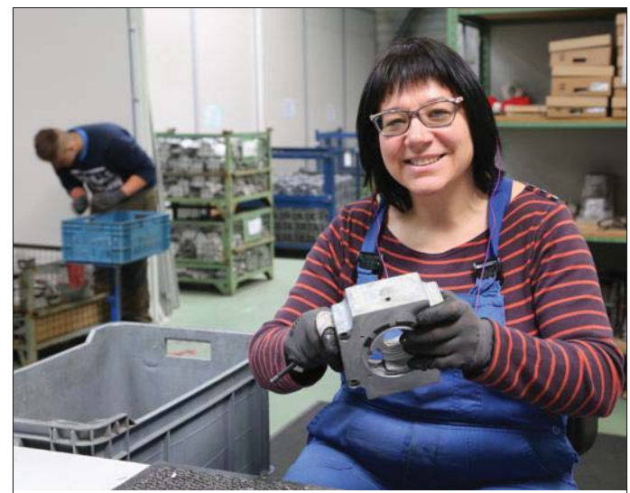
En juin dernier, l'Esat a signé un contrat avec l'entreprise SEW, qui lui confie des pièces en aluminium sur lesquelles il faut enlever les bavures.
